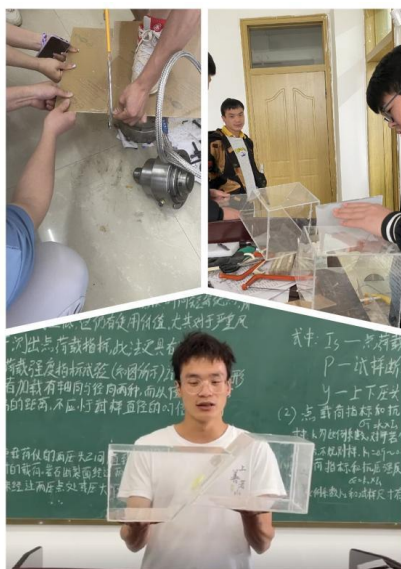
图 5 正断层和逆断层力学特征演示模型
